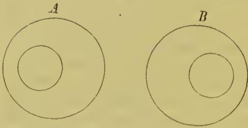
Nun denken Sie sich zwei entsprechende Zeichnungen, *A* und *B*, Fig. 51 eine für das rechte und die andere für das linke Auge, in's Stereoscop gelegt, so
